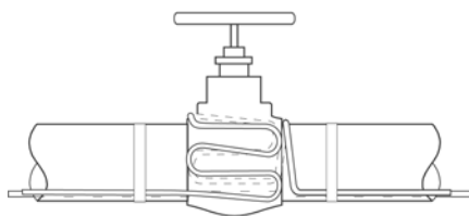
Pose sur des vannes
