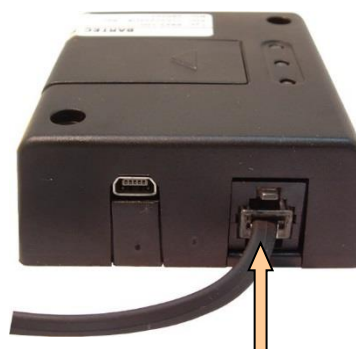
Anschluss für Stromkabel
